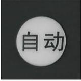
按键，市电正常时，运行在待命状态，如果市电断开，此时延时 3 秒钟后，控制屏就自动按程序运行：预供、起动、升速、合闸，进入正常工作状态。在合闸后延时 15 秒进入监察状态，此时如机组发生油压低、转速高、转速低、机温高、电压高、电压低、过流、短路时，都会自动报警停机，记忆并显示故障点。
